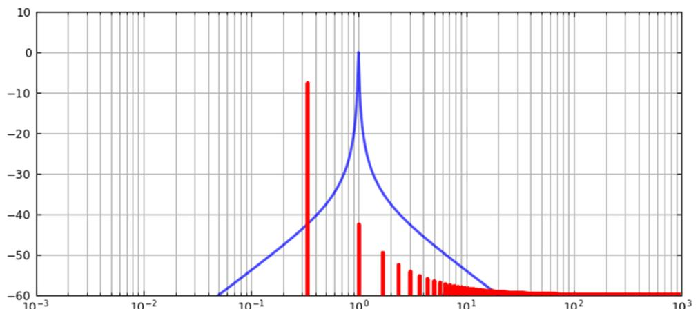
L'objectif de la prochaine expérience est de « vérifier expérimentalement » la décomposition en série de Fourier du signal créneau.
